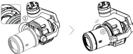
5. Поверните объектив камеры против часовой стрелки, чтобы убедиться, что он надежно закреплен.
