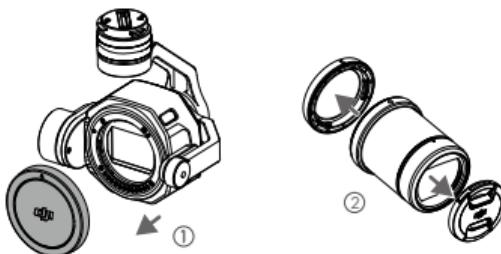
3. Совместите два указателя крепления объектива на корпусе камеры и объективе и вставьте объектив камеры в ее корпус.
